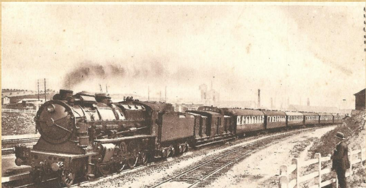
Ce train est tracté par une Super Pacific de la Cie du Nord sous l'œil d'un admirateur. Derrière la locomotive, un fourgon truck qui permettait de charger et décharger rapidement les conteneurs avec les bagages des passagers à Calais ou Douvres, plusieurs couplages de pullman. La blancheur du toit du 3ème pullman détonne ! On est vers la fin des années 20 ou début des années 30 (Collec. Eric Comont).
