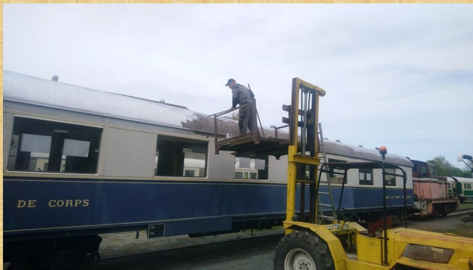
Le montage peut sembler peu orthodoxe, mais il est efficace pour traiter la toiture, il ne faut pas oublier que nos associations font aussi avec leurs moyens techniques disponibles. Collec. CFV
