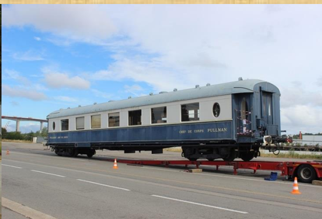
Le pullman est en cours de chargement sur la plateforme routière surbaissée du camion, grâce au plan incliné et à un treuil (Collec. Eric Comont)
